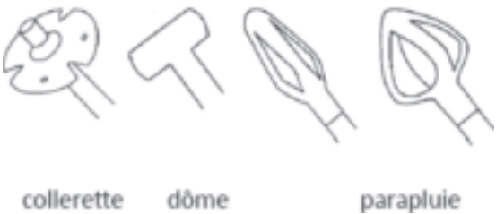
Figure 2 : Extrémités des sondes de GPE.
